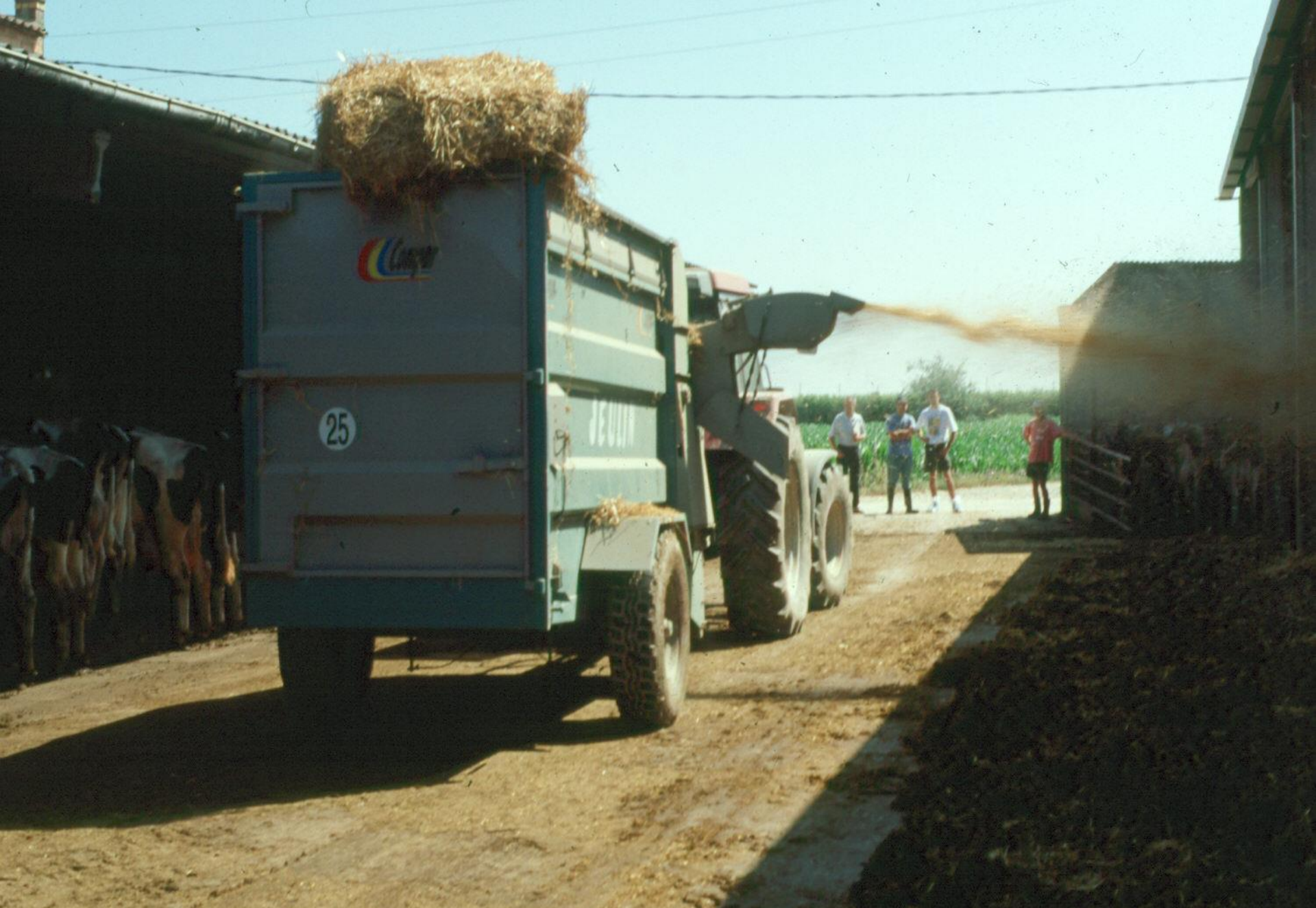
Màquina de fer jaç o empallotadora arrossegada (també pot ser suspesa)
