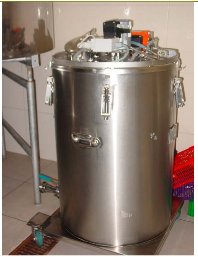
Dipòsit isotèrmic de 230 l per al dispensador de llet
