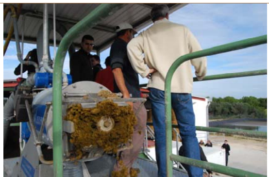
Separador de sòlids del fens
