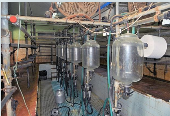
Sala de munyir espina de peix 2x6 en el darrer dia de funcionament
