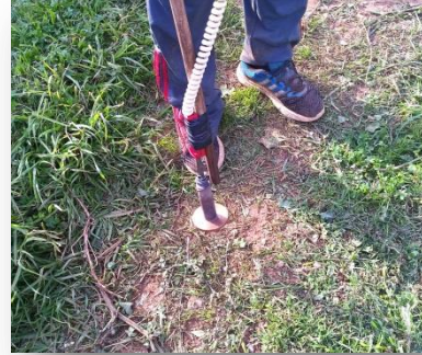
Herramienta – quemador- para agujerear la malla
